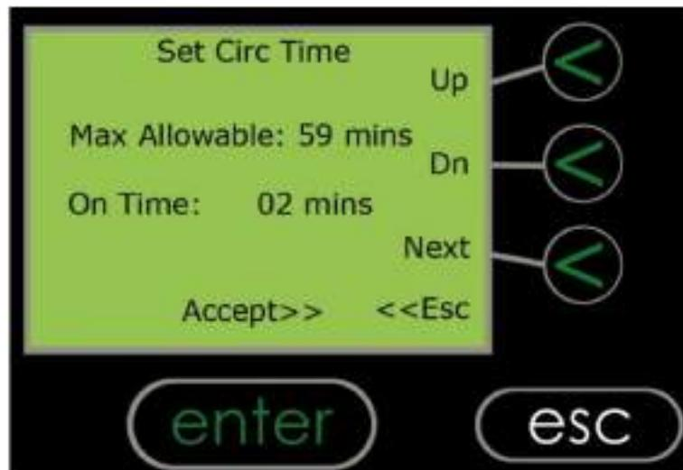
На заводе в **IND6427VPD** устанавливается время работы насоса 2 минуты. Его следует увеличивать только в том случае, если внешняя насосная система присоединена к установке.
