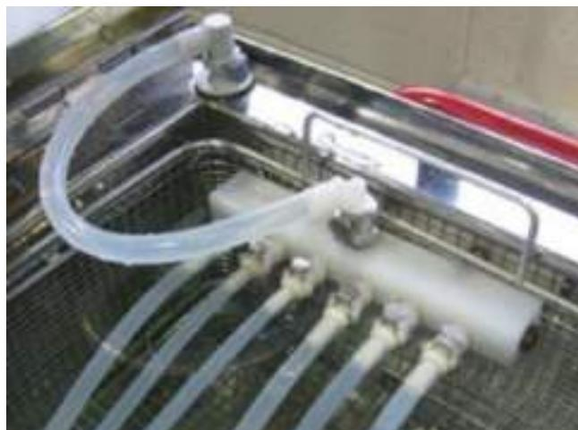
2. Присоединить корзину, вставив соединитель в адаптер Люэра, расположенный в верхней части емкости.
