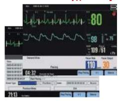
В устройстве BeneHeart D6 предусмотрена неинвазивная кардиостимуляция по команде и в фиксированном режиме, с настраиваемыми частотами и выходным сигналом.
