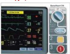
Ручной дефибриллятор, автоматический наружный дефибриллятор (АНД), кардиостимулятор и монитор в одном устройстве. Интуитивный выбор режима. Простое проведение дефибрилляции (пошагово: 1-2-3).
