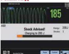
В режиме АНД дефибриллятор-монитор автоматически анализирует сердечный ритм и определяет необходимость разряда. Голосовые и текстовые подсказки направляют пользователя в ходе процесса. Доступна также запись речи.
