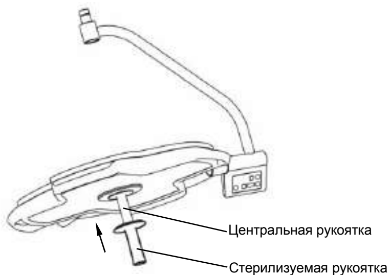
Рисунок 2-3. Установка стерилизуемой рукоятки
