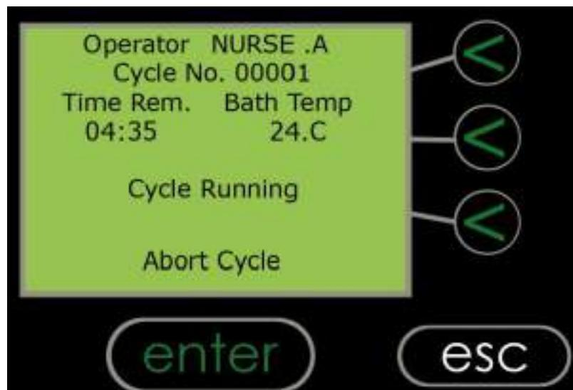
Цикл может быть прерван в любое время путем нажатия кнопки «Abort Cycle» («Остановка цикла»).
