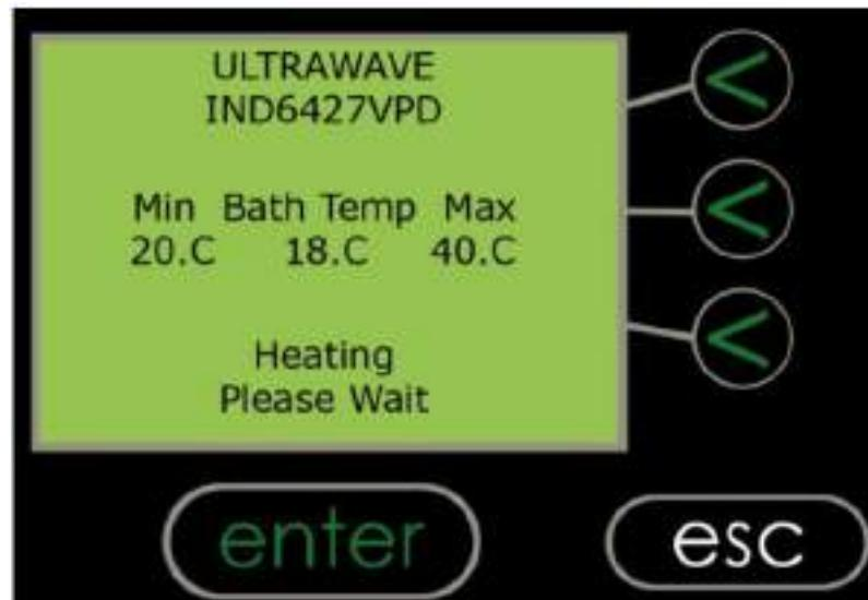
Ванна **IND6427VPD** начинает нагрев и дегазацию жидкости в автоматическом режиме. Когда жидкость достигает заданной температуры, отображается следующий экран, что означает готовность ванны **IND6427VPD** к работе (фактическая минимальная и максимальная температура может отличаться от значений, указанных ниже).
