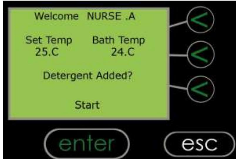
Нажать кнопку «Start» («Пуск») для подтверждения присутствия моющего средства в жидкости.
