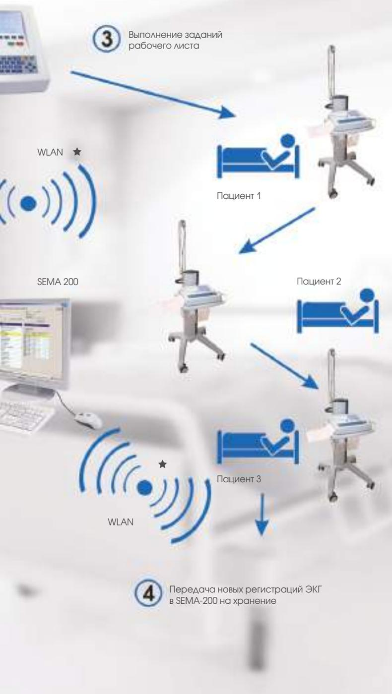
Дополнительный коммуникационный модуль SCHILLER (SCM) соединяет AT-102 с системой управления данными SEMA-200 для оптимизации рабочих процессов и расширения функциональных возможностей. Этот модуль обеспечивает двусторонний обмен данными не только с SEMA-200, но также с системами ГИС и EMR через LAN, WLAN или стандартный модем.
